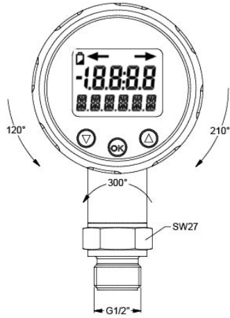
G1/2" flush DIN 3852 PN ≥ 1 bar
